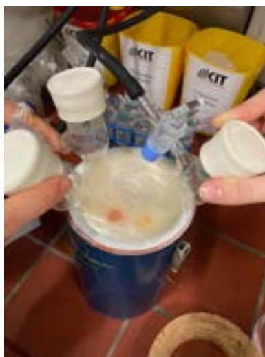
Abb. 5: Freeze-Pump-Thaw Methode: Eintauchen der Schlenkrohre in flüssigen Stickstoff
