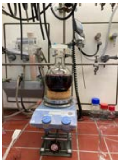
Abb. 3: Versuchsaufbau für die Methanol-Wasser-Gemisch-Extraktion
