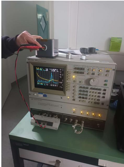
Abbildung 14: Impedanzmessung eines Transducers. Die Frequenz mit einem Wendepunkt in  $|Z|$  wird als optimal definiert.
