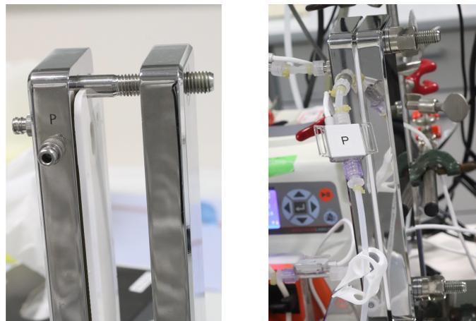
Abbildung 2: links: Membran mit geöffnetem Gestell, rechts: Membran angeschlossen
