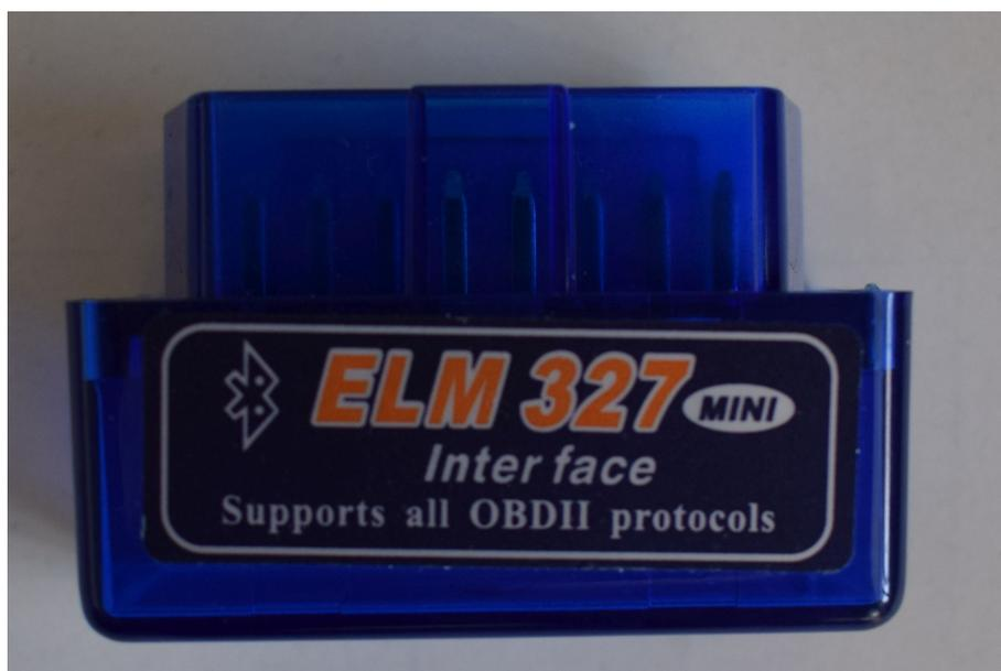
Abbildung 3.3: Der verwendete *ELM327*-kompatible OBD-Adapter
